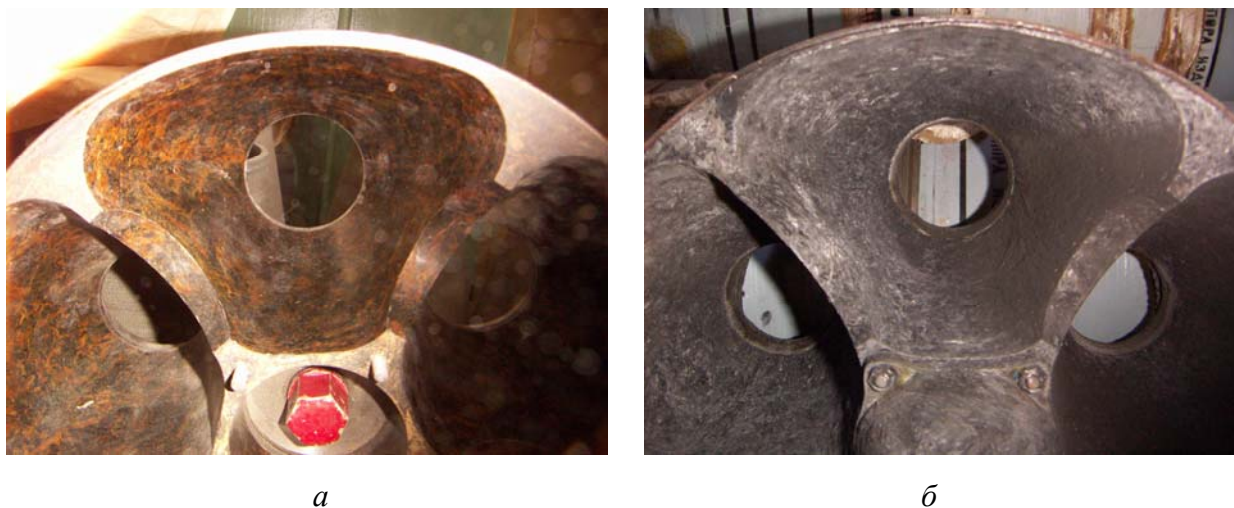
Рис. 8. Многосопловой блок с некруглыми соплами до и после испытаний.
