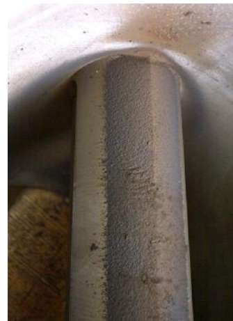
Рис.3. Вид загрязненной лобовой поверхности обтекаемого тела вихревого расходомера
